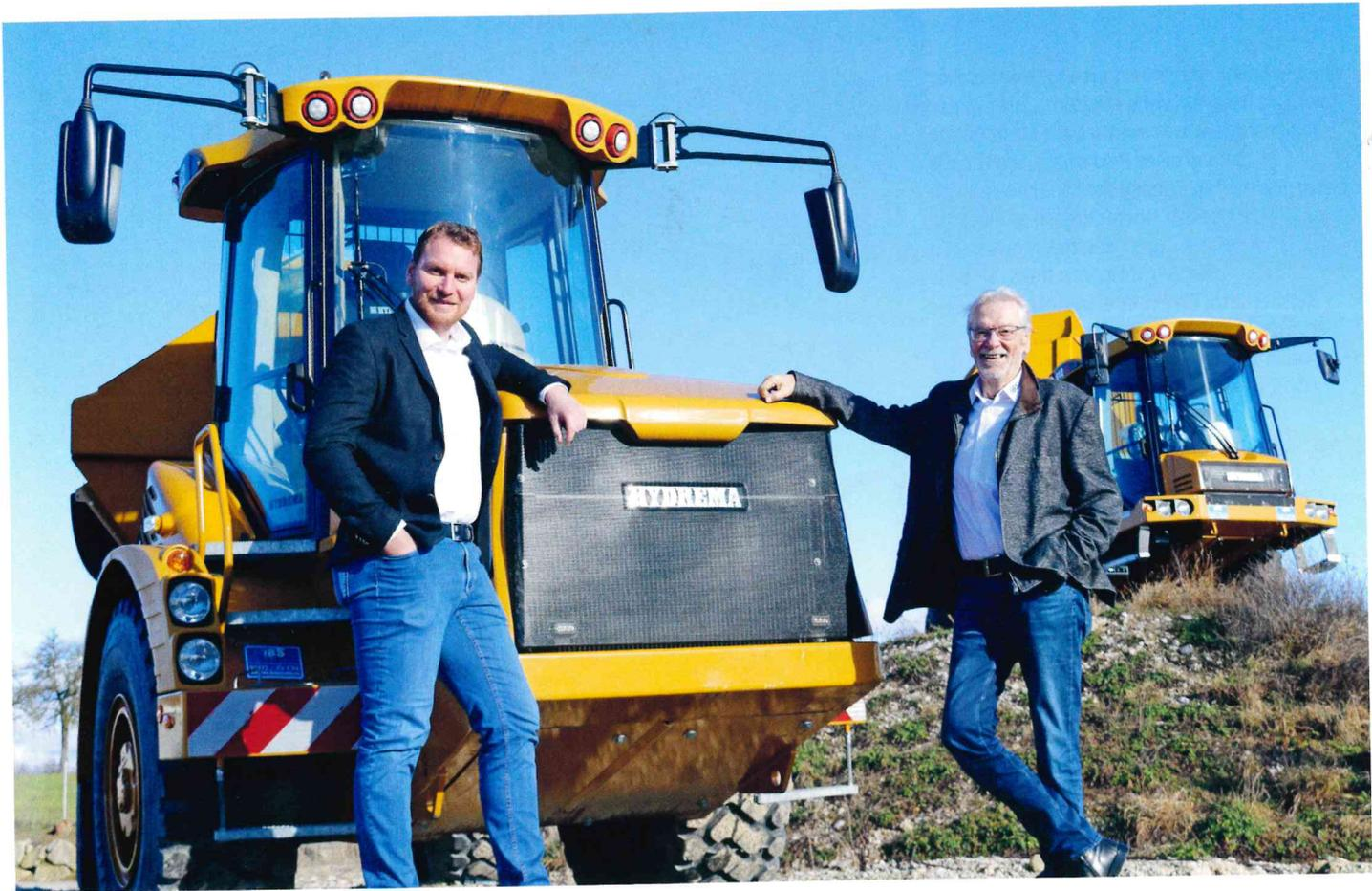
IBS Austria betreut als Vertriebspartner die hochwertigen Produkte von Sennebogen, Hydrema, Dieci und Minelli in ganz Österreich. Im Bild der knickgelenkte Muldenkipper Hydrema 922G der 20 t Klasse und im Hintergrund der kompakte Muldenkipper 912GS der 10 t Klasse.
